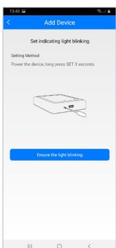
Alimenter la LENNY-WIFOX1 à 5V 500mA via le micro-USB. Si la LED "SYS" ne clignote pas, appuyez sur la touche "SET" et maintenez-la enfoncée pendant 3 secondes.
