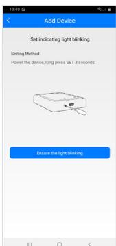
Ligue o LENNY-WIFOX1 a 5 V 500 mA por meio do micro-USB. Se o LED do dispositivo "SYS" não estiver piscando, pressione o botão "SET" no dispositivo por 3 segundos.
